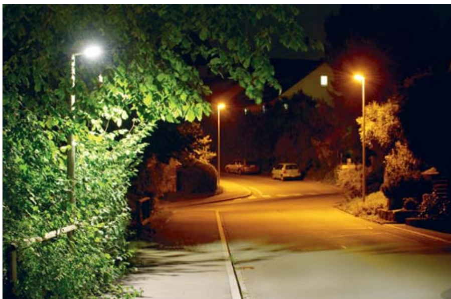
Die neuen LED-Leuchten in Wädenswil mit weisslichem, hellerem Licht: Sie verursachen weniger Streulicht – im Vergleich zur Natriumdampf Lampe im Hintergrund.
